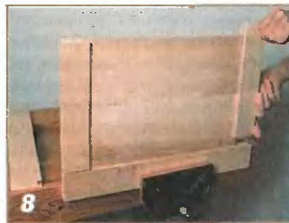
Для проверки точности подгонки всех деталей собрал дверцу насухо.
