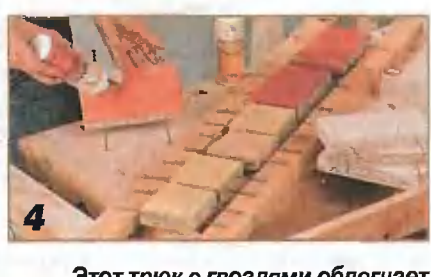
Этот трюк с гвоздями облегчает покрытие лазурью вертикальных деталей спинки, вырезанных из березовой многослойной фанеры.
