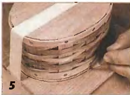
Чтобы гарантировать ровный выступ, с помощью шайбы переводят обвод шкатулки на скрепленные детали крышки.
