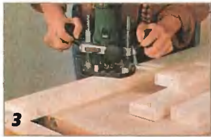
Кромки всех четырех досок сиденья скругляют фрезерной машинкой.
