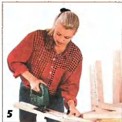
Фигурные детали (верхнюю деталь спинки и продольную связь между ножками) аккуратно выкраивают электролобзиком.
