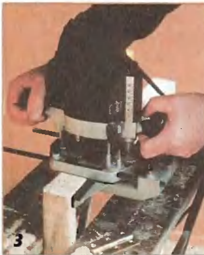
3 Гнезда для оконных петель выбирают фрезерной машинкой.
