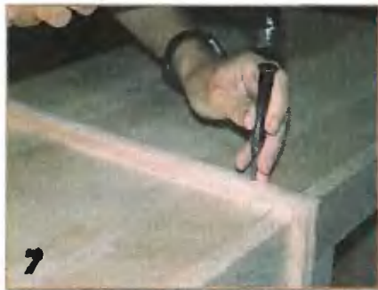
Планки прикрепил к каркасу на клею и штифтами.
