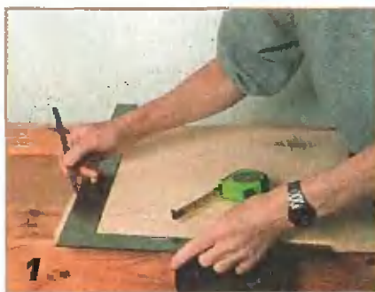
1 Точные размеры полки я разметил рулеткой и угольником.
