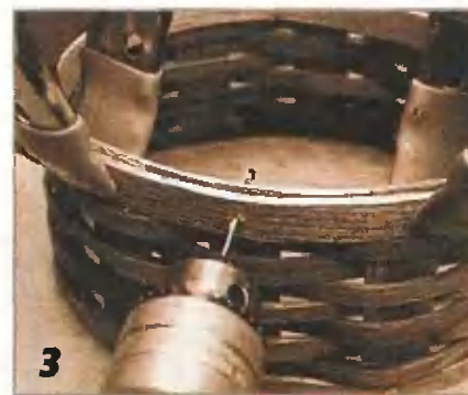
Сверлят отверстие Ø 1,5 мм через верхнюю внешнюю ленту, стойку и верхнюю внутреннюю ленту.
