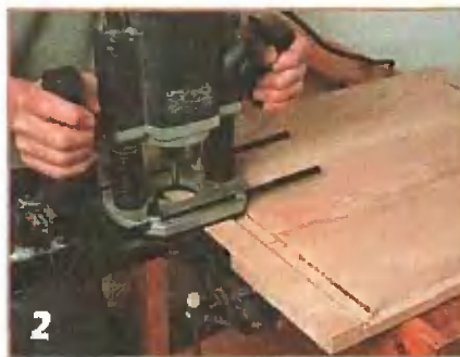
2 Для боковых стенок на нижней стороне крышки выбрал два паза.
