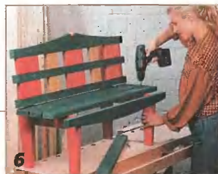
При сборке изделия последними крепят продольную связь и доски сиденья.
